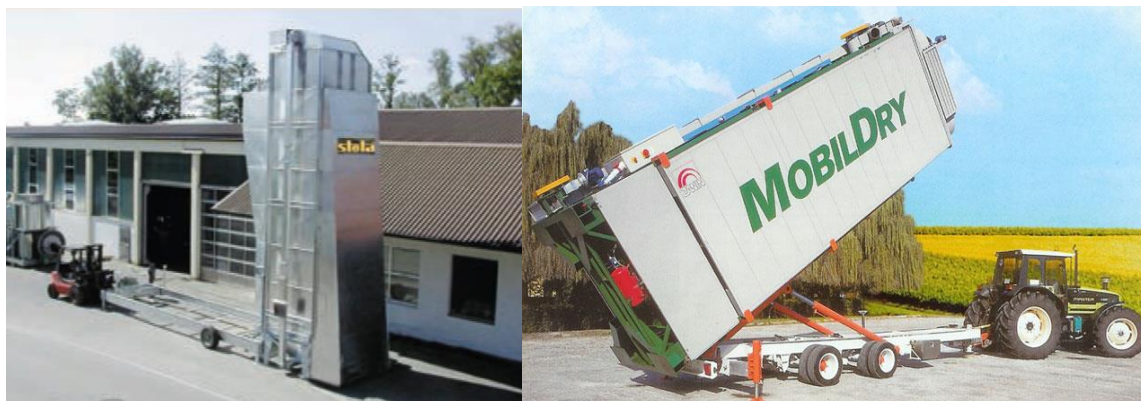
Рис. 4. Опрокидываемые зерносушилки: а - мобильная опрокидываемая сушилка Universal фирмы «Stela» (Германия);
