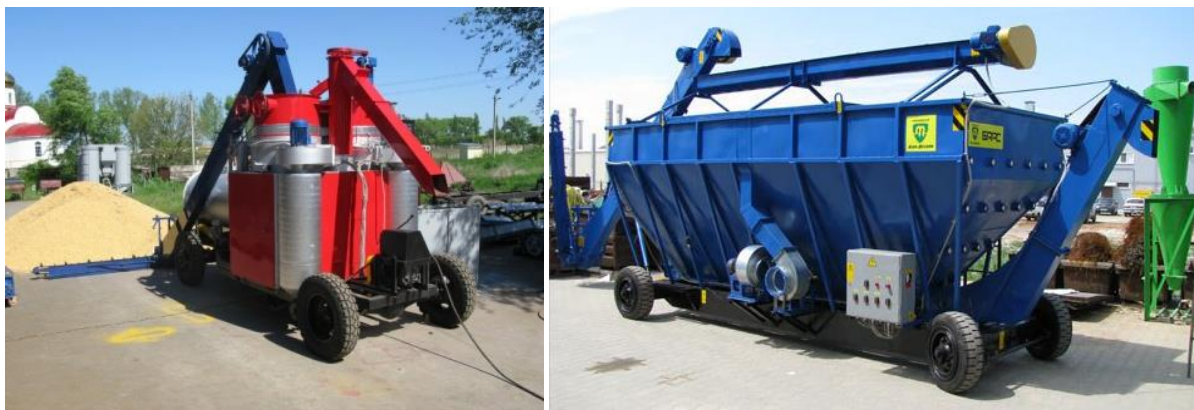
Рис. 5. Самопередвижной зерносушильный комплекс (ССК) «БАРС-С» фирмы НПО «Вымпел» (Россия): а - сушильный модуль; б - аэратор
