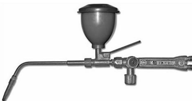
Рис. 5. Установка для нанесения газопламенного напыления на опытные образцы
