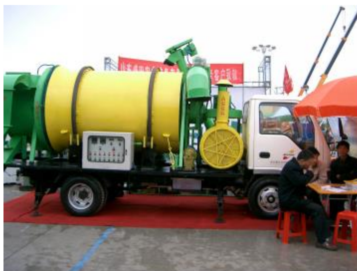
Рис. 8. Монтируемая на грузовой автомобиль зерносушилка Мобильная барабанная зерносушилка ZY5T фирмы «Zhengzhou Zhengyang Machinery Equipment Co., Ltd»
