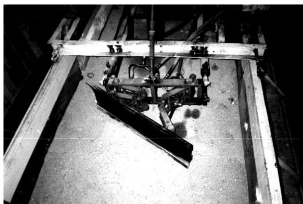
Рис. 6. Рабочий орган бульдозера установлен под углом в плане
