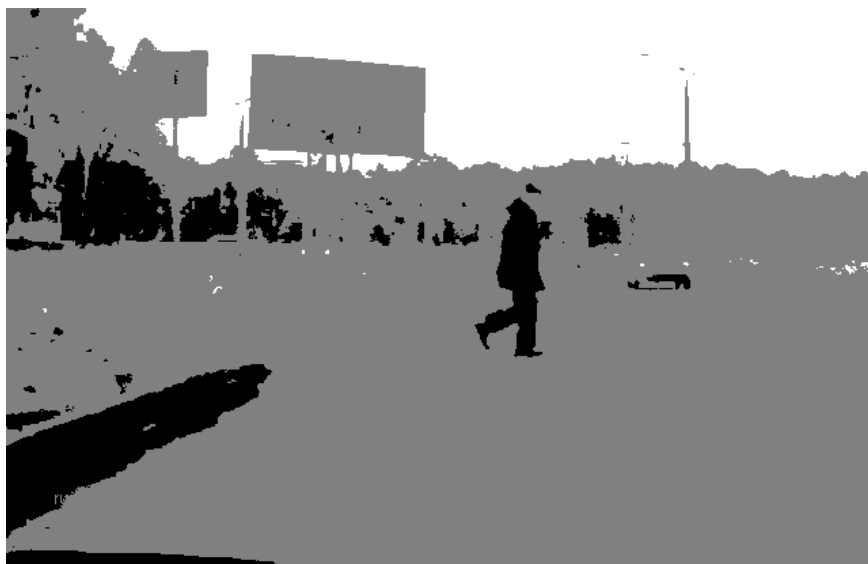
Рис. 1. Полученное изображение проезжей части после применения операции перехода к серым оттенкам и постеризации с уровнем 3
