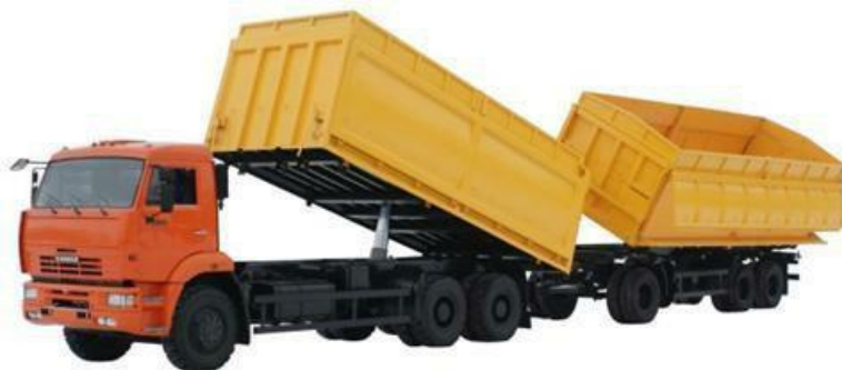
Рис. 1. Автопоезд самосвальный 68901Е на шасси КамАЗ-65115 с прицепом 853100
