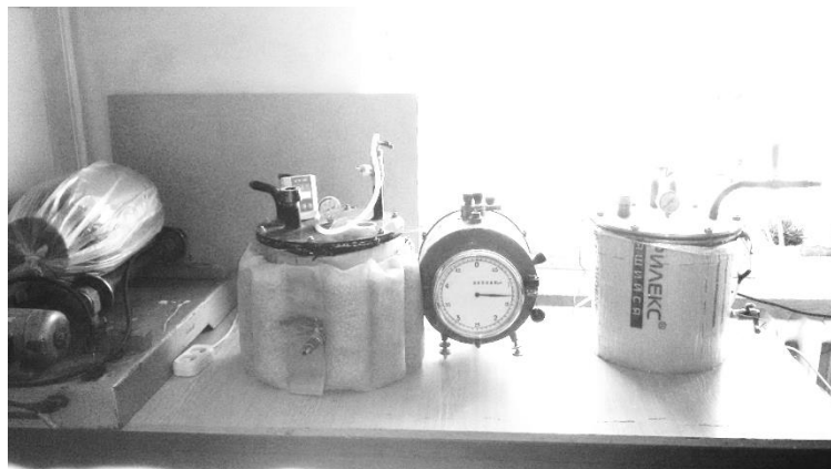
Рис. 2. Внешний вид опытной установки анаэробного сбраживания обезвоженного избыточного активного ила
