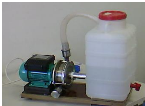
Рис. 2. Переносная роторно-пульсационная установка
